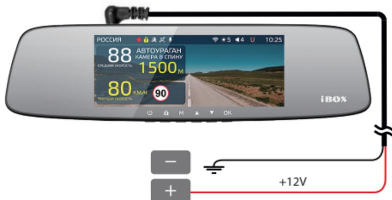
Кабель питания **iBOX 24H Parking monitoring cord DC3,5 R1** позволяет не допустить критической разрядки аккумулятора автомобиля. В каком бы режиме ни работал видеорегистратор, кабель автоматически отключает его питание при падении напряжения ниже 12,0 В для аккумуляторов с напряжением 12 В и ниже 23,2 В для аккумуляторов с напряжением 24 В.
